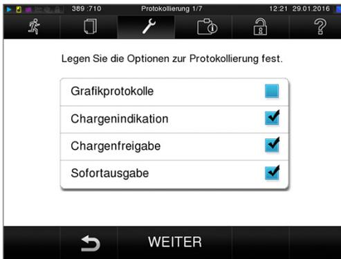
**Chargenindikation** umfasst die Überprüfung der im Sterilisierprogramm mitgeführten Indikatoren, z.B. MELAcontrol/MELAcontrol Pro. Nur bei einem vollständigen Farbumschlag der Indikatorstreifen kann die Freigabe der Indikatoren erfolgen.
